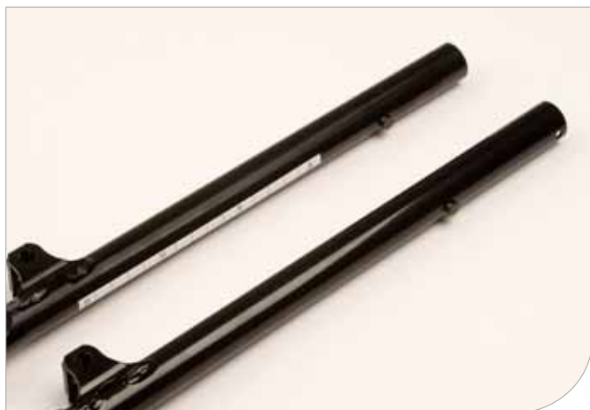
Ryggrör lackat i ED-lack (vänster) och pulverlack (höger)
